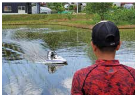
田植え時には除草剤散布ボートを活用
